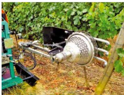
▲ Fig. 1. Nelle defogliatrici termiche, un flusso di aria generato da un ventilatore viene riscaldato a più di 70 °C tramite un bruciatore a gas e colpisce le foglie più esterne, in modo da provocare il collasso dei vasi linfatici
