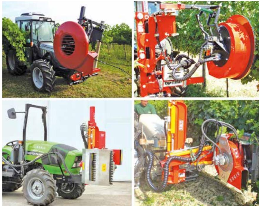
▲ Fig. 2. Sia con il taglio di lame rotanti (sopra) che tramite lo strappo ad opera di una coppia di rulli mungitori (sotto), le defogliatrici meccaniche asportano la voluta quantità di fogliame con un'azione immediata
