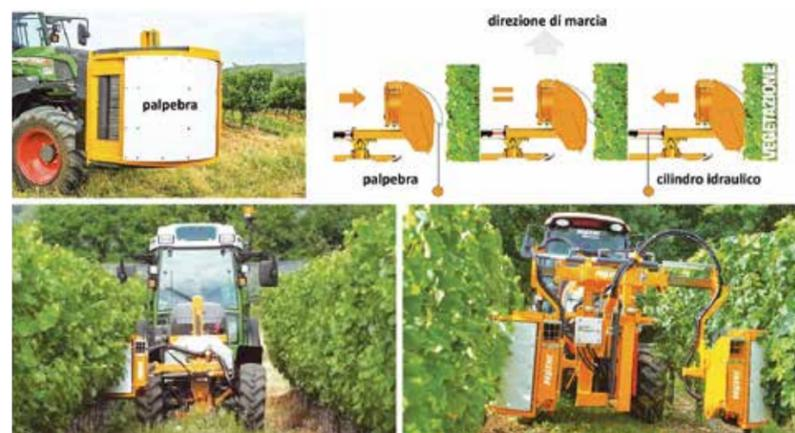
▼ Fig. 6. Il tastatore meccanico (la "palpebra", in alto a sinistra) rileva la resistenza alla pressione della vegetazione, e per il tramite di un cilindro idraulico muove la testata per regolare l'intensità di asportazione del fogliame (in alto a destra). La testata può essere singola reversibile oppure doppia (sotto)
