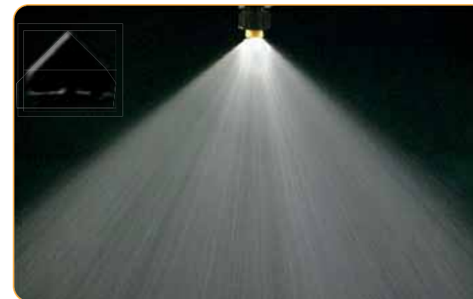
Herbicíd + Grounded, 200 l/ha, tlak 2 bar
